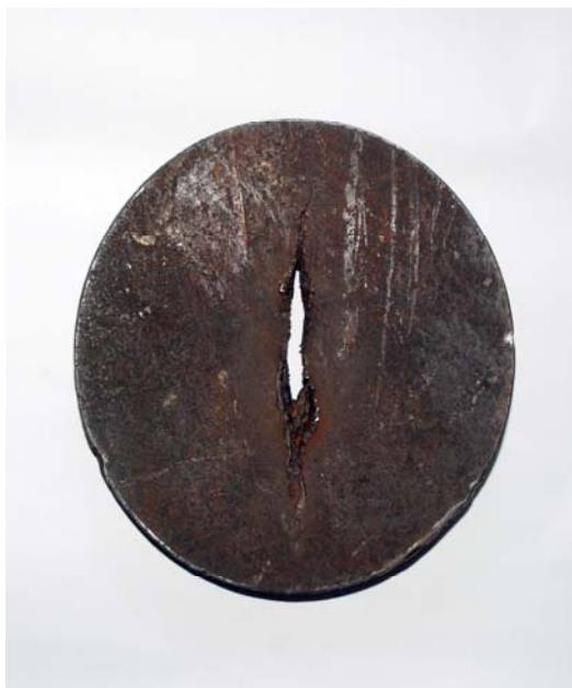
Рис. 2 - Характер руйнування сталюого листа товщиною 10 мм і діаметром 180 мм
