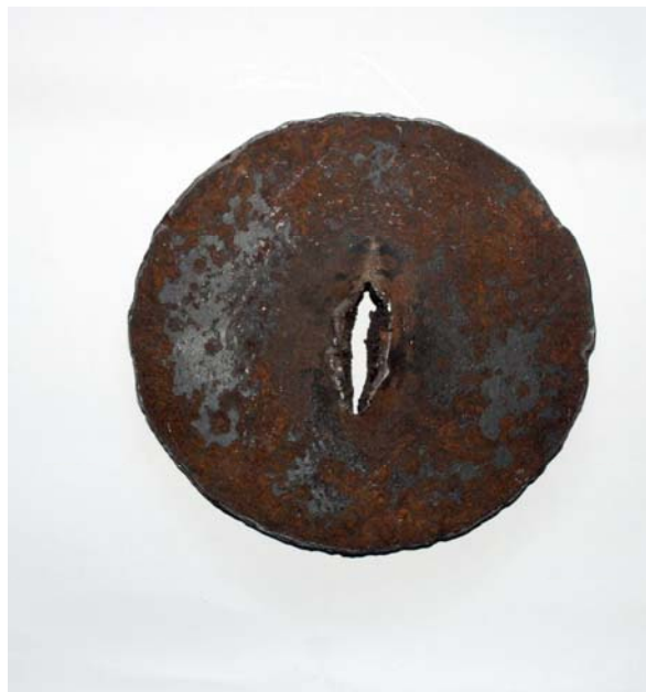
Рис. 2 - Характер руйнування сталюого листа товщиною 10 мм і діаметром 180 мм
